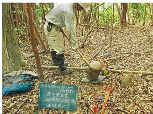
写真2. 3. 1-4 カケヤによる起振状況
