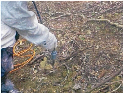
写真2.3.1-1 受振器の設置（左）とテークアウトケーブルによる接続（右）
