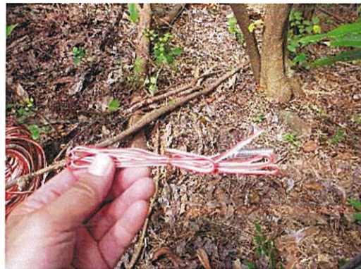
写真 2. 3. 1-2 起振に用いたコンクリート破砕剤、ガンサイザー（左）とイグナイター（右）
