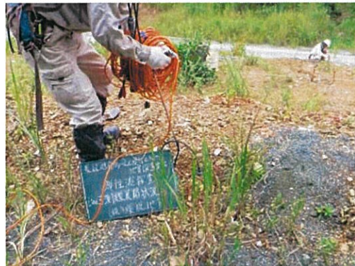
写真2.3.1-1 受振器の設置（左）とテークアウトケーブルによる接続（右）
