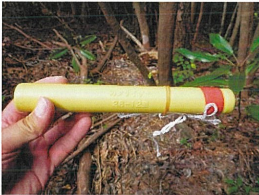
写真 2. 3. 1-2 起振に用いたコンクリート破砕剤、ガンサイザー（左）とイグナイター（右）
